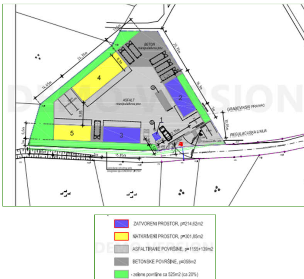
Slika 3: Reciklažno dvorište Općine Stubičke Toplice (Izvor: , Općina Stubičke Toplice, Zrcalo-inženjering d.o.o. Ivanec)
