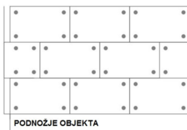
4 pričvrstnice/ploča ili 6 kom/m 2 fasade
