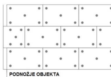
5 pričvrstnica/ploča ili 8 kom/m 2 fasade
