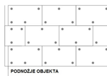
5 pričvrstnica/ploča ili 8 kom/m 2 fasade
